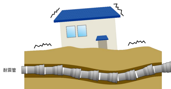
耐震管地震時管路イメージ
