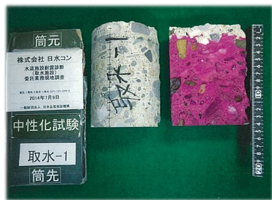
コンクリート中性化試験
